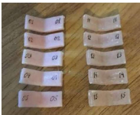
Рисунок 57 - Группы экспериментальных образцов из материала Vertex ThermoSens после проведения испытания на трехточечный изгиб
