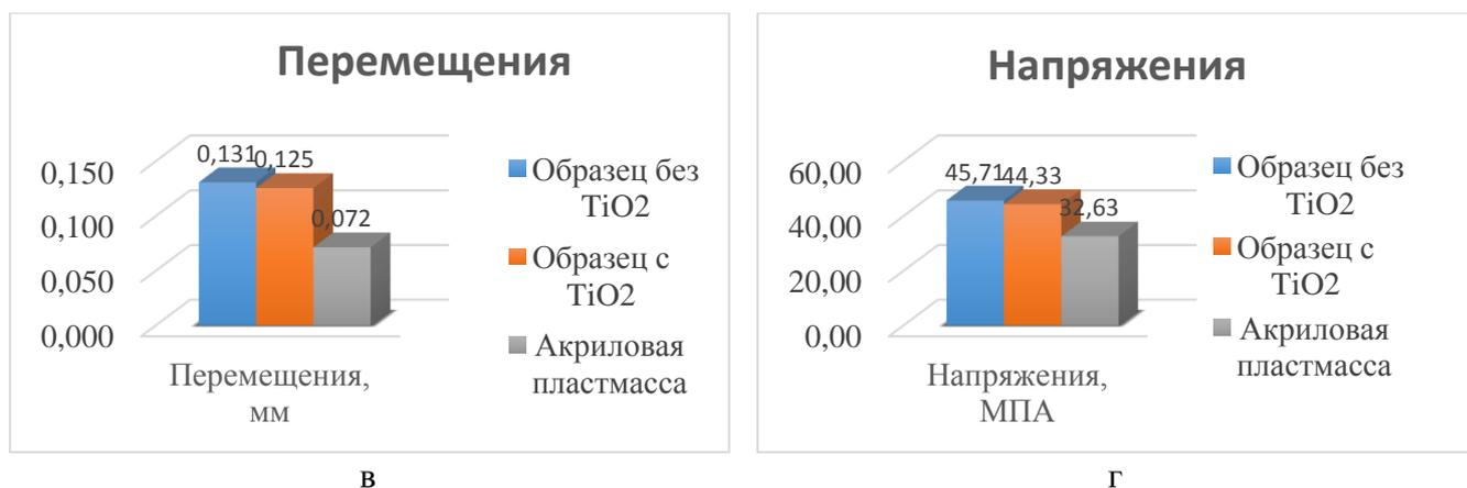
Рисунок 86 - Максимальные перемещения (а) и напряжения (б) при вертикальных нагрузках; максимальные перемещения (в) и напряжения (г) при горизонтальных нагрузках
