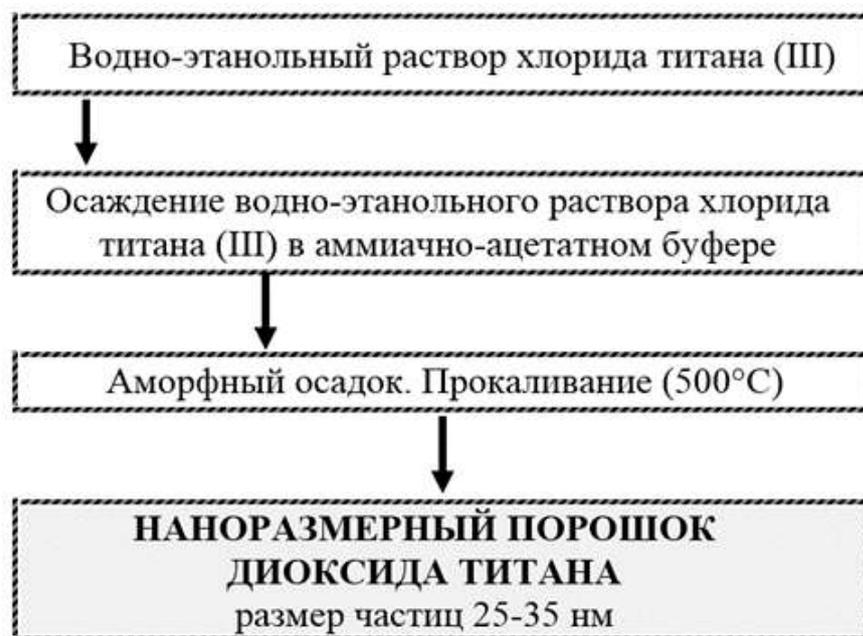
Рисунок 5 - Блок-схема этапов получения наноразмерного порошка диоксида титана
