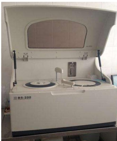
Рисунок 20. Автоматический биохимический анализатор BS-200 Chemistry Analyzer (Mindray, Китай).
