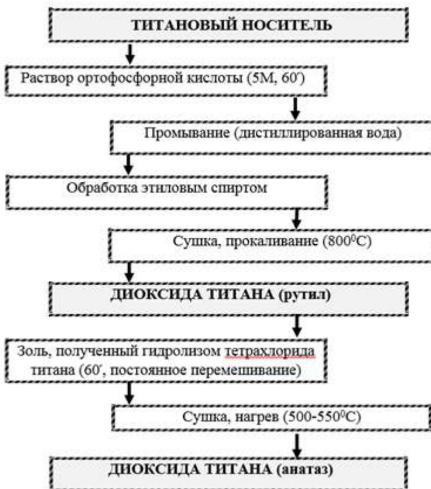
Рисунок 7 - Блок-схема этапов нанесения наноструктурированного диоксида титана на экспериментальные образцы
