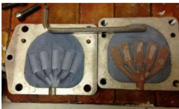
Рисунок 9 - В кювете для термопрессования - готовые образцы для исследований
