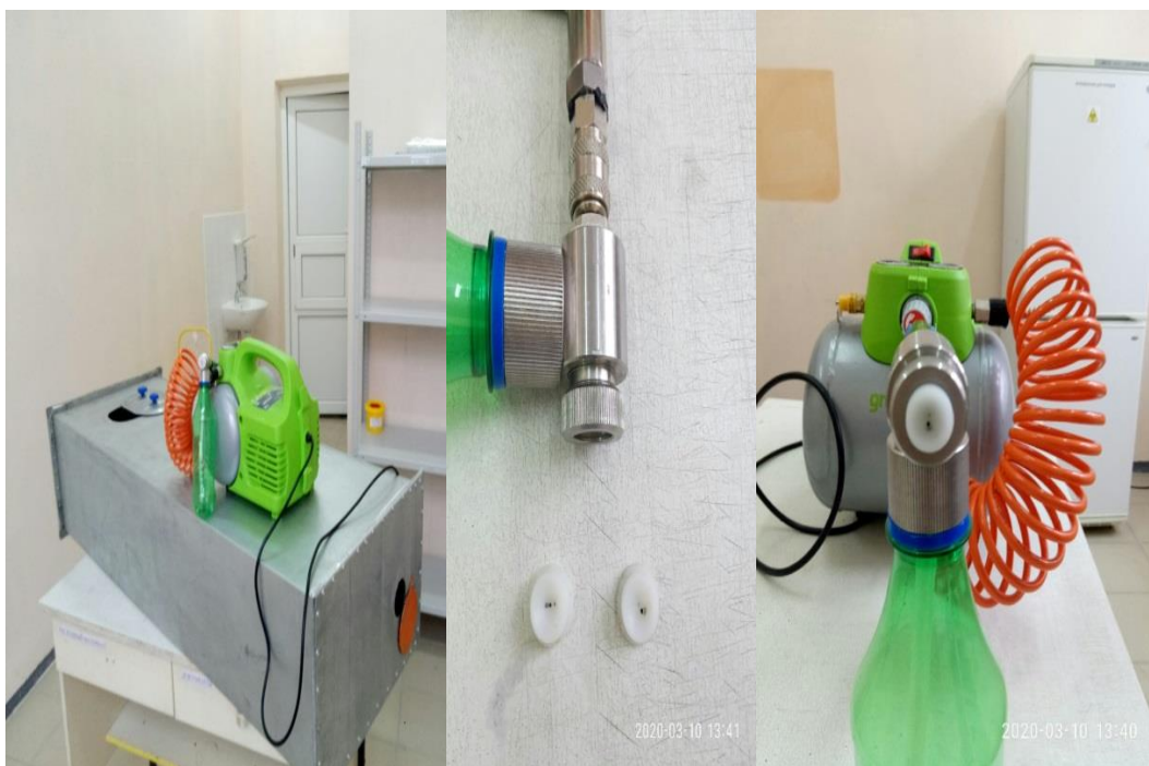
Рисунок 57 Комплект оборудования для аэрозольной дезинфекции (компрессор на 6 атм., гибкий спиральный воздуховод, малярный пистолет, генерирующий аэрозоль 5-25 мкм)
